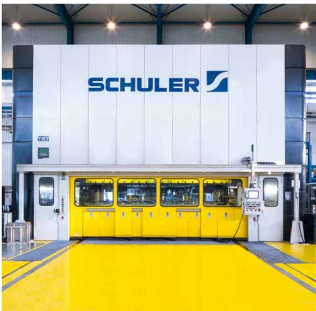
Transferpresse mit TwinServo Technologie.
