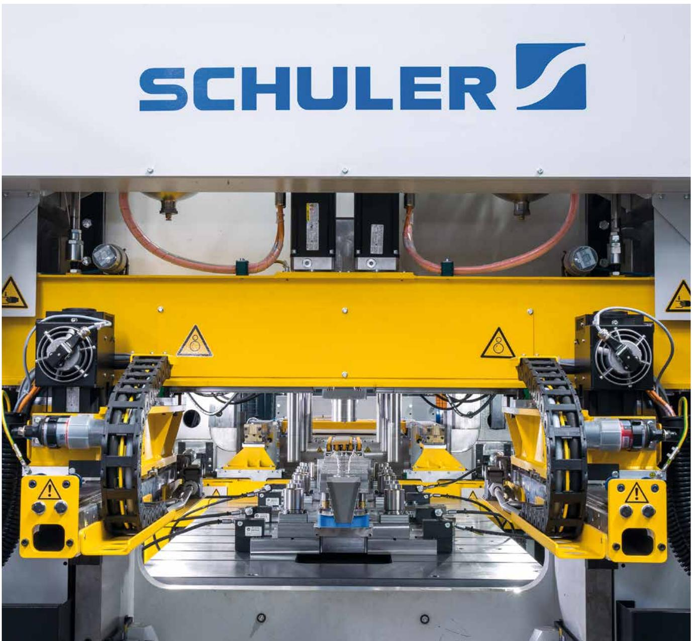
Drei-Achs-Transfer »ProTrans« mit Servoantrieb.
