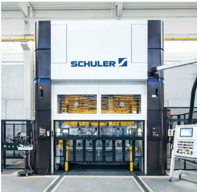
Servopresse in Monoblockbauweise mit 2.500 bis 10.000 kN Presskraft.
