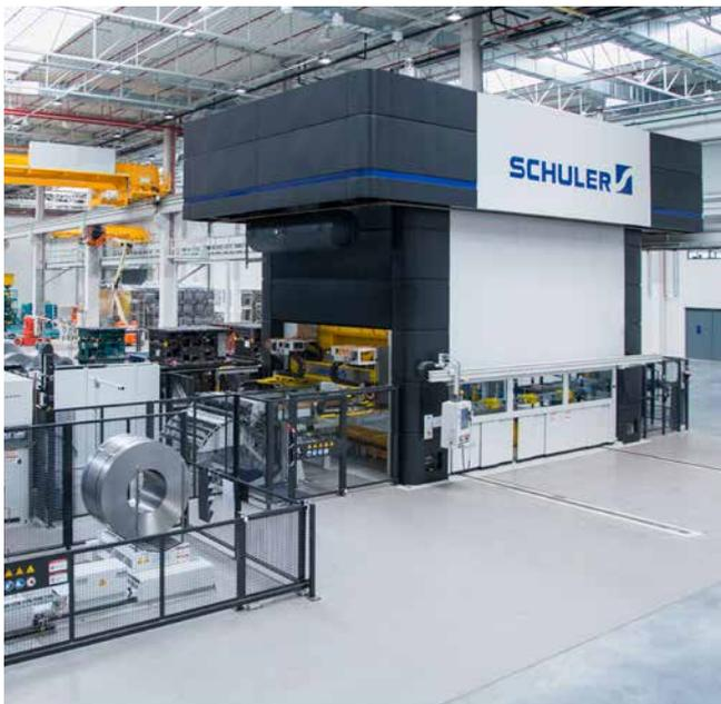
Servopresse in Zugankerbauweise.
