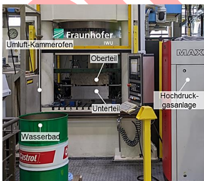
Abbildung 6 (links) Experimenteller Versuchsaufbau für IHU-Versuche mit W-Temper-Umformen sowie Umformen unter Abschreckbedingungen. (rechts) Versuchsplan und Prozessbedingungen
